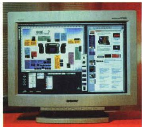
24 pollici di diagonale, rapporto d'aspetto in 16:10, griglia di apertura variabile per ottimizzare la restituzione delle immagini sull'intera superficie del display; ecco in sintesi il nuovo GDM-W900 Sony Trinitron.
